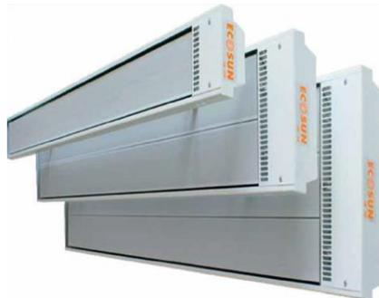
Grundelement ist ein in einer Aluminiumlamelle eingepresster Heizstab. Je nach der zugeführten Leistung der Heizplatte werden eine, zwei oder drei Lamellen verwendet, die in ein Gehäuse aus lackiertem Stahlblech eingebaut sind. Die Lamellen sind mit einer SILICATING-Schicht zur wesentlichen Erhöhung der Ausstrahlung der Heizteile versehen.
